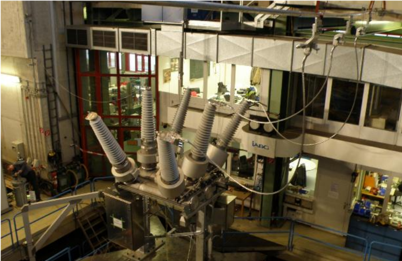
HYpact subissant un essai sur table vibrante
