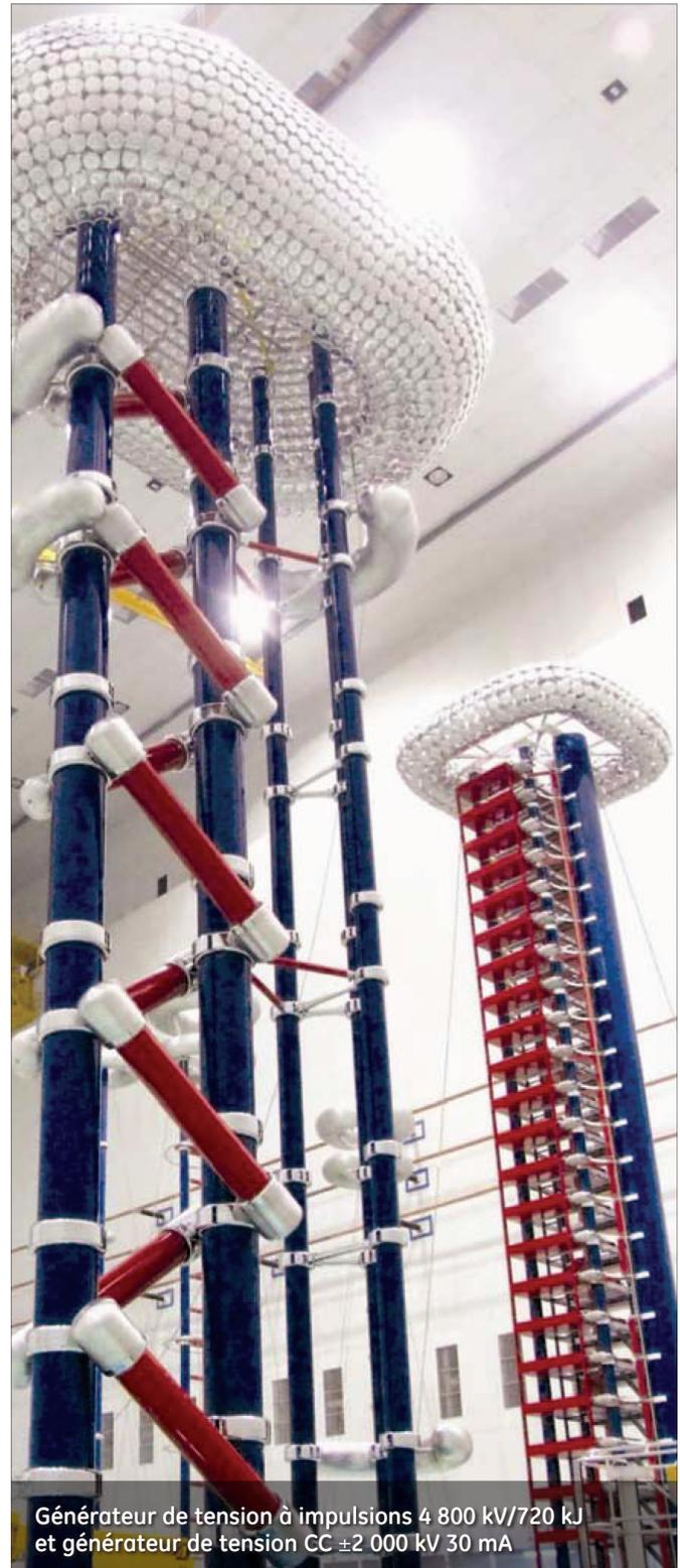
Générateur de tension à impulsions 4 800 kV/720 kJ
