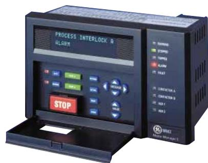
Se puede solicitar el montaje en panel con display al pedir los dos paquetes opcionales. Se monta en el panel frontal del CCM con su display alfanumérico de 2 x 20, un teclado completo y 11 LEDs de estado expuestos al operario para una visualización local completa y programación de ajustes. Los ajustes se pueden cargar también en el relé a través del puerto de comunicaciones RS485.
