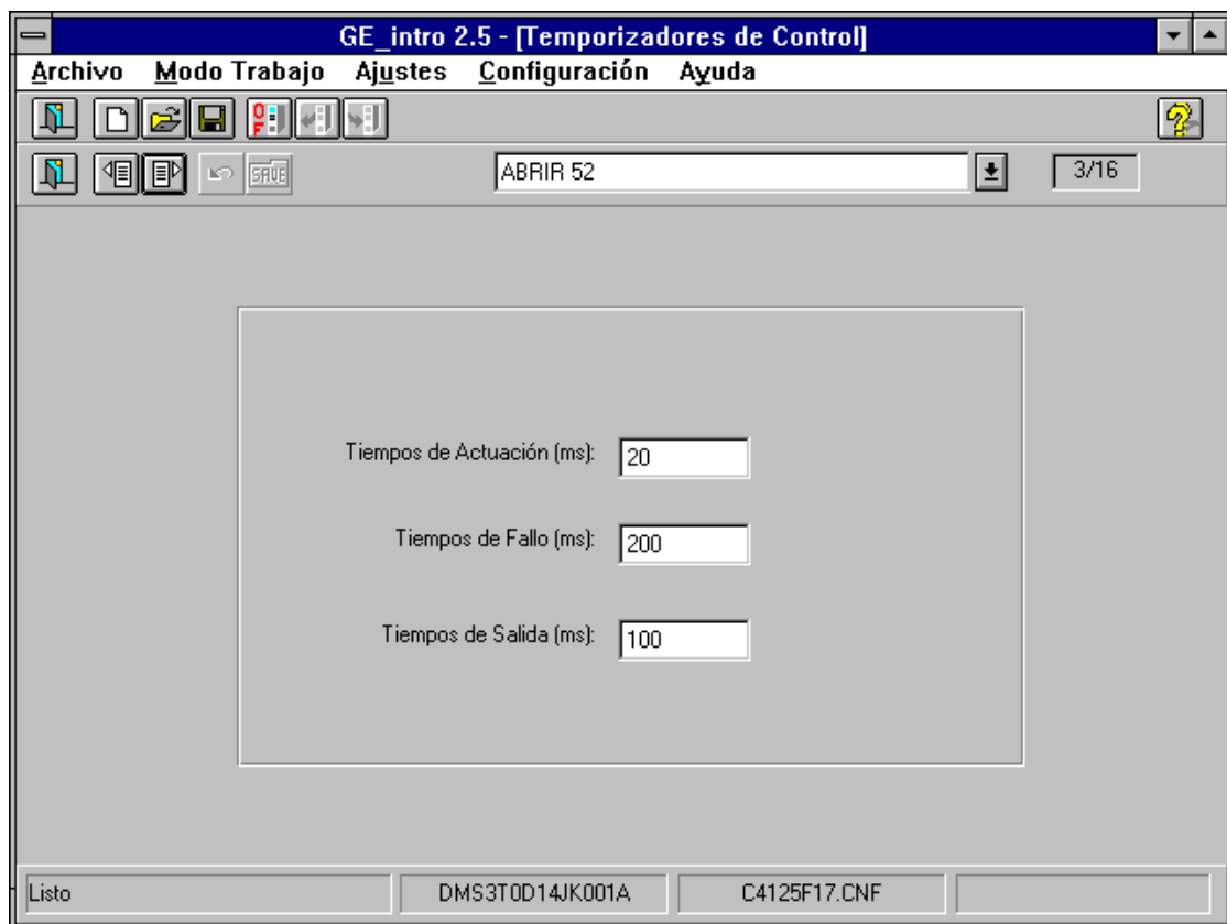
Figure 25. Temporisateurs de Manoeuvres..
